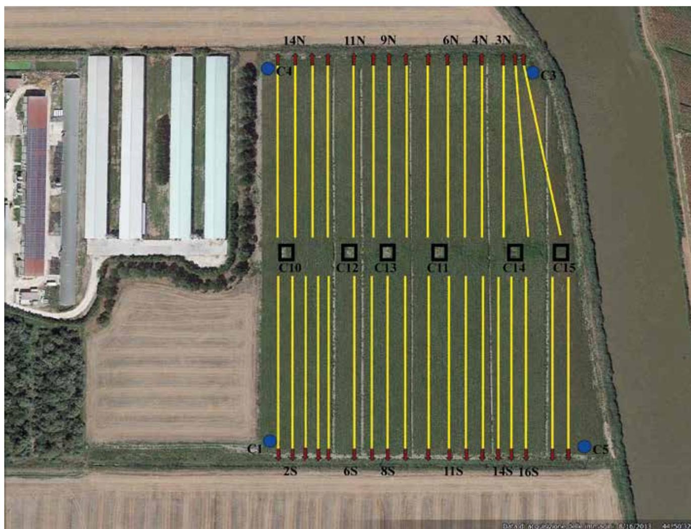
**Figura 6:** Rappresentazione del sistema di drenaggio del campo sperimentale, che comprende 15 dreni a nord e 18 dreni a sud. Il dreno utilizzato per ciascuna parcella (sia lato nord che lato sud) è identificato con la sigla riportata.
