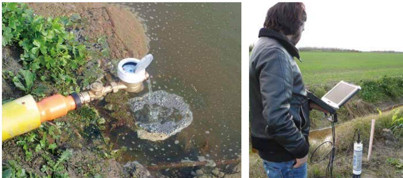
**Figura 7:** Esempio di conta-litri installato nella parte terminale dei dreni del campo sperimentale e misurazione della concentrazione delle specie azotate (ammonio e nitrato) presenti nell'acqua immessa nel sistema idrico superfice.
