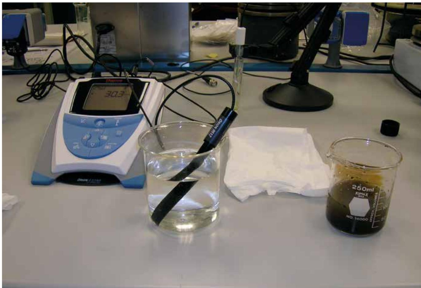
Foto 6 - I test di scambio tra zeolite e liquame suino
