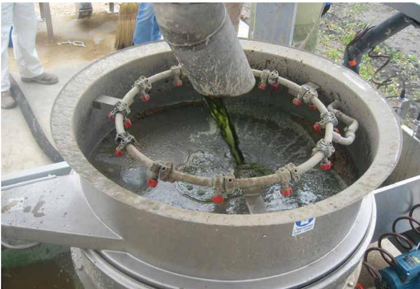
Foto 8 - Particolare del vibrovaglio per la separazione della zeolite dopo il trattamento
