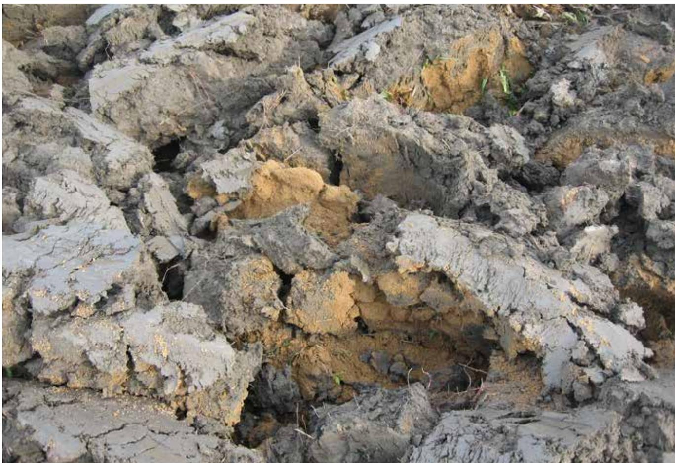
*Foto 18 - La zeolite miscelata al terreno limoso-argilloso*
